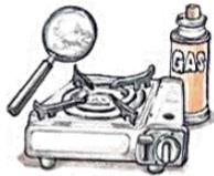
2. 安裝卡式瓦斯罐時，應將瓦斯罐上之「環扣缺口」朝上，與卡式爐上凸出之「導引片」對正後再接合，確認無瓦斯洩漏後，再點火烹煮。
