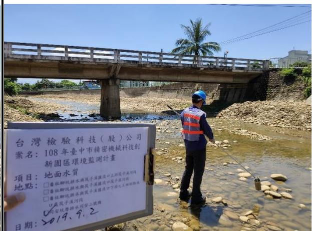
地面水質監測站---同安坑厝排水同安二號橋(108.09.02)
