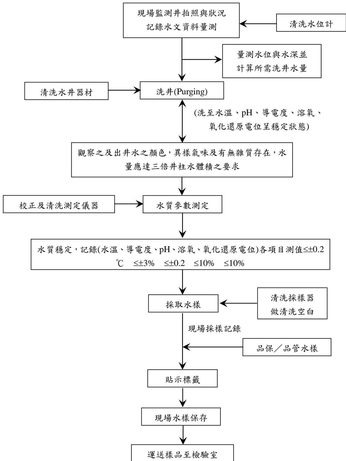
圖 1.5.1-5、地下水樣品採集作業流程圖
