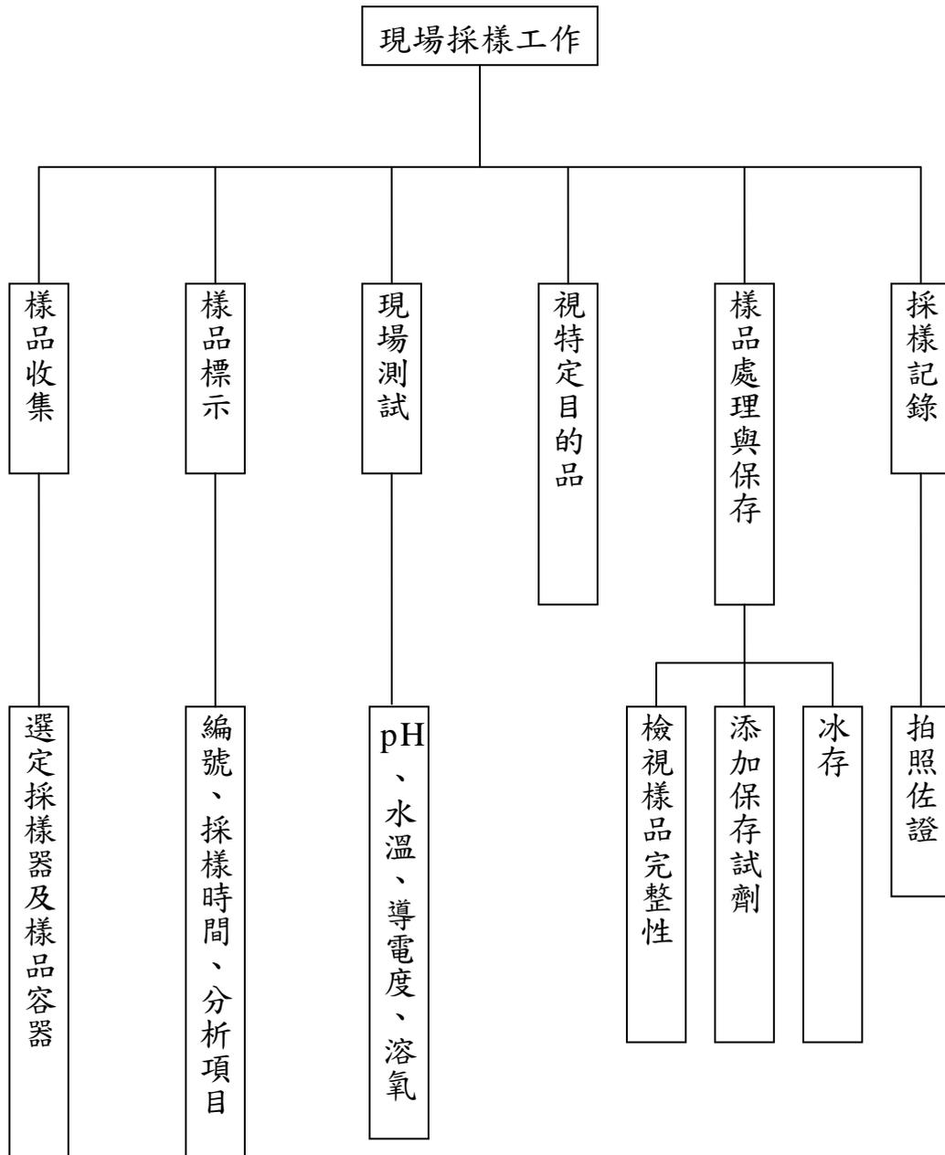
圖 1.5.1-3、水質樣品採集作業流程
