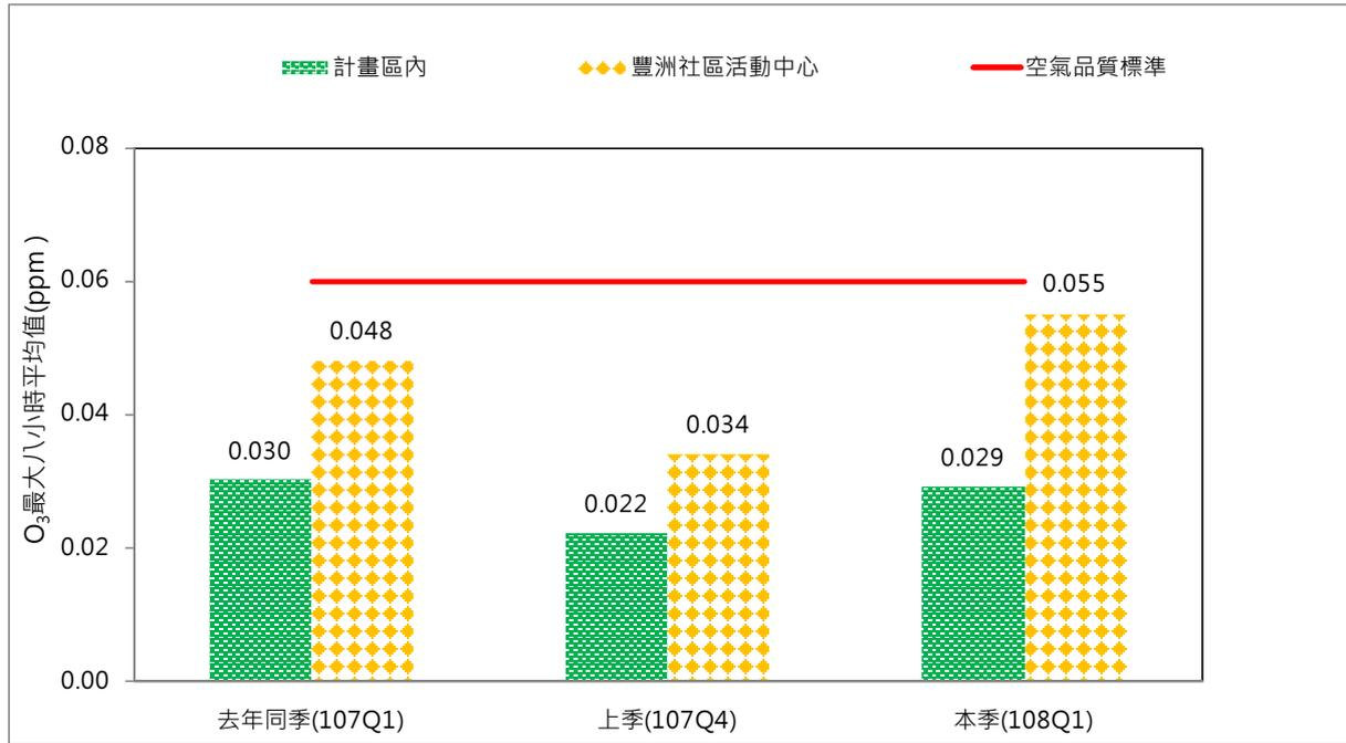
圖 3.1.1-41、本季、上季與去年同季施工暨營運期間空品 O<sub>3</sub> 最大八小時平均值監測成果
