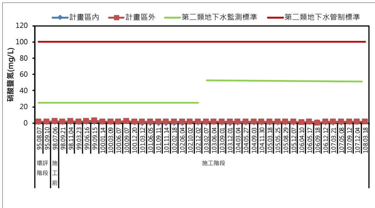
圖 3.1.1-30、歷次地下水質硝酸鹽氮監測結果
