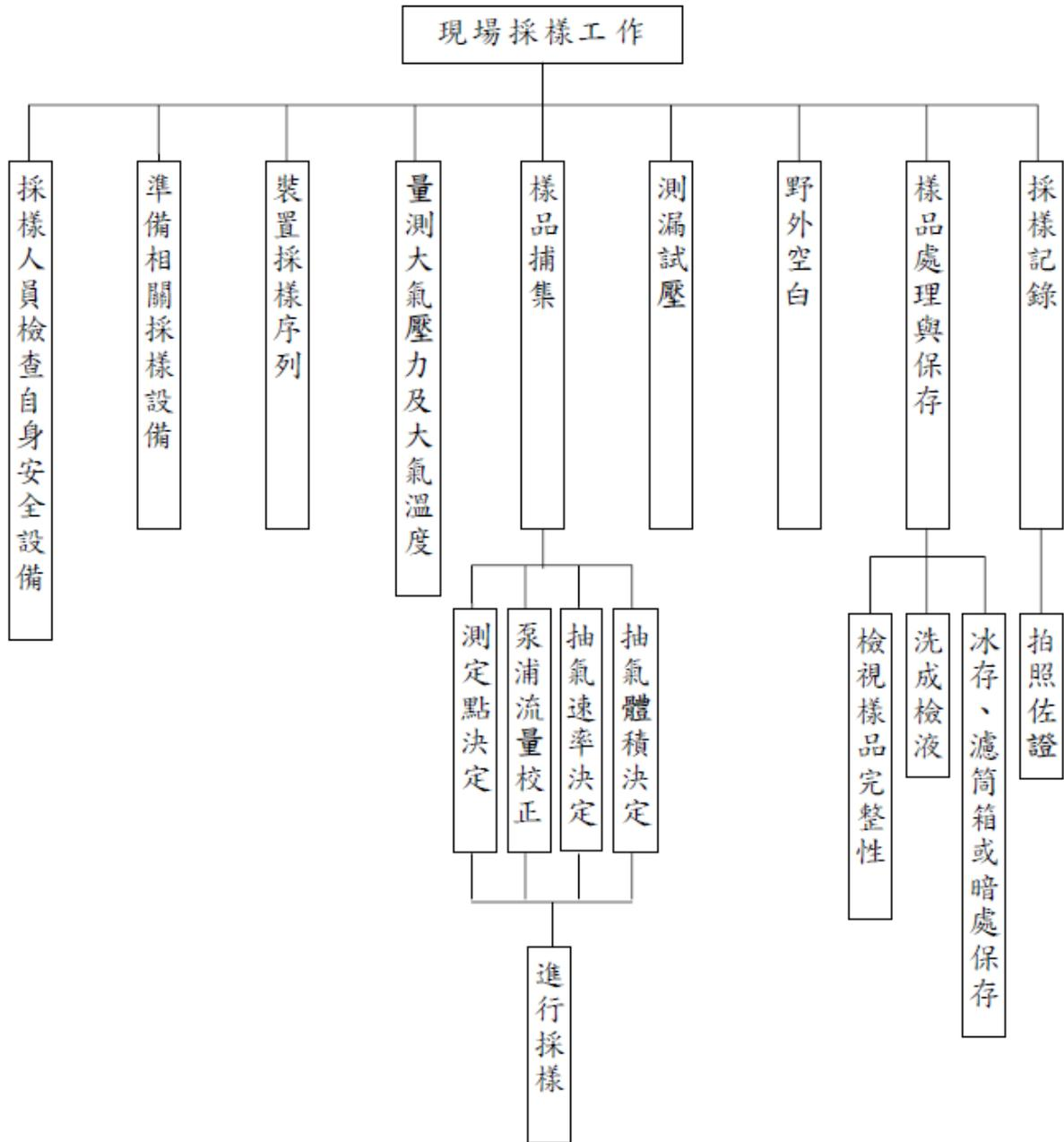
圖 1.5.1-2、其他空氣類別檢測作業流程
