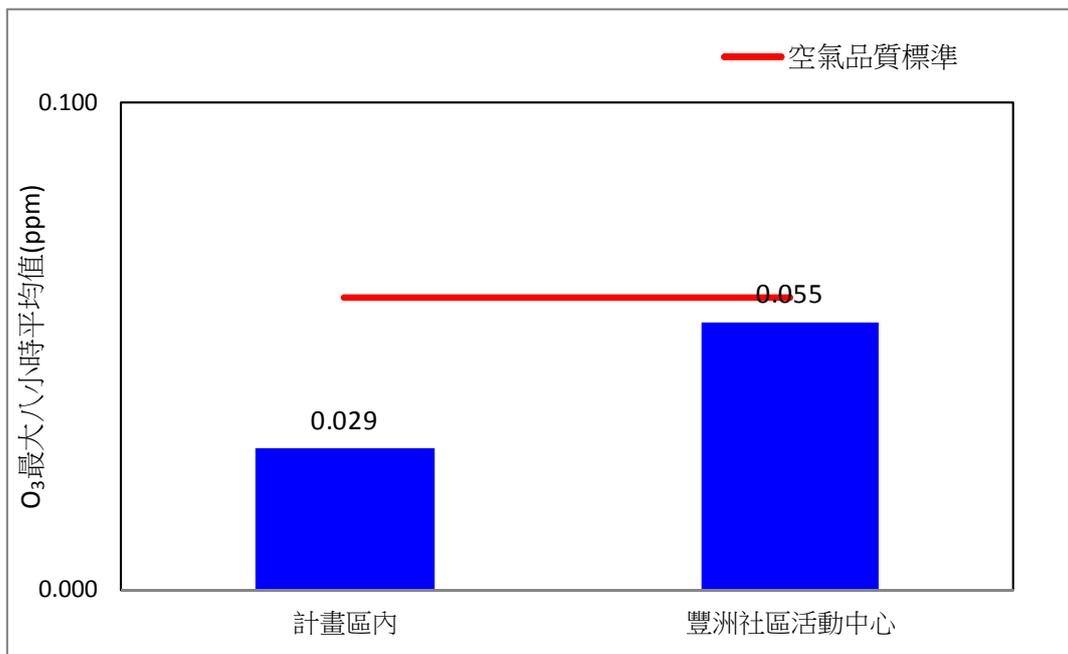
圖 2.3-10、108 年第一季空氣品質 O<sub>3</sub> 最大八小時平均值監測比較圖
