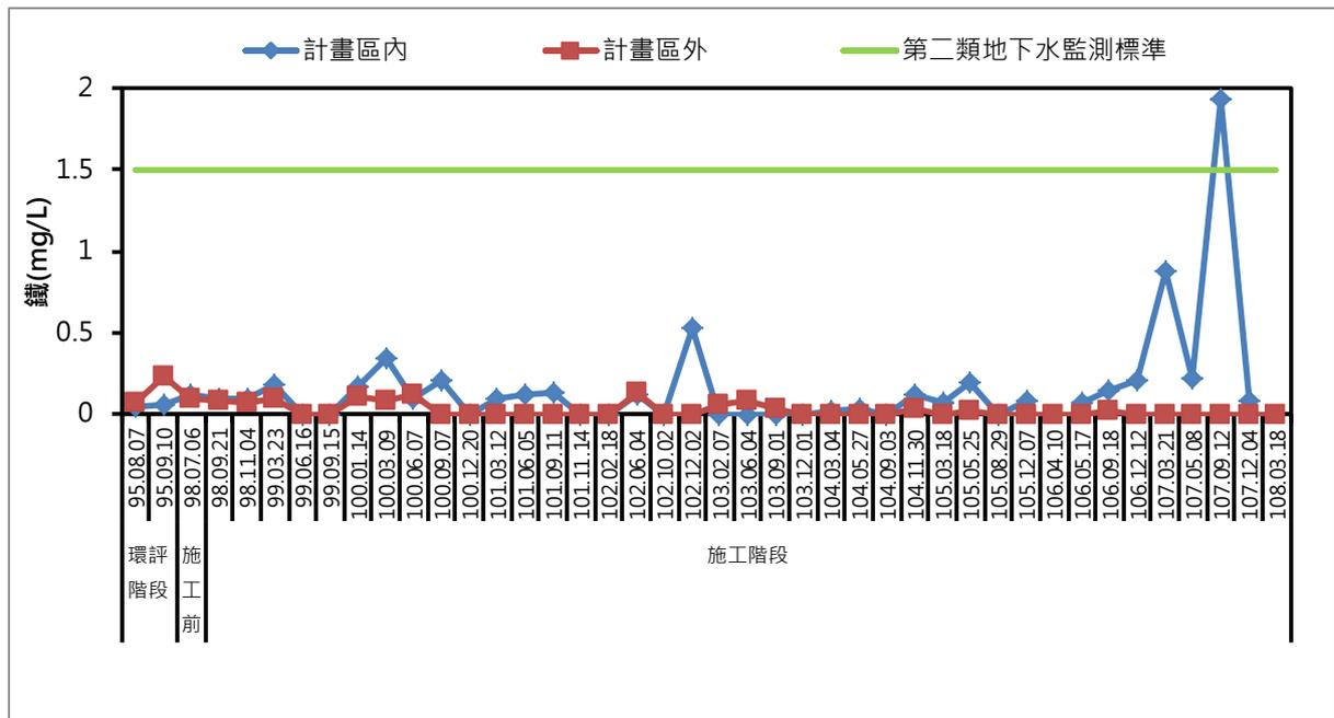
圖 3.1.1-32、歷次地下水質鐵監測結果
