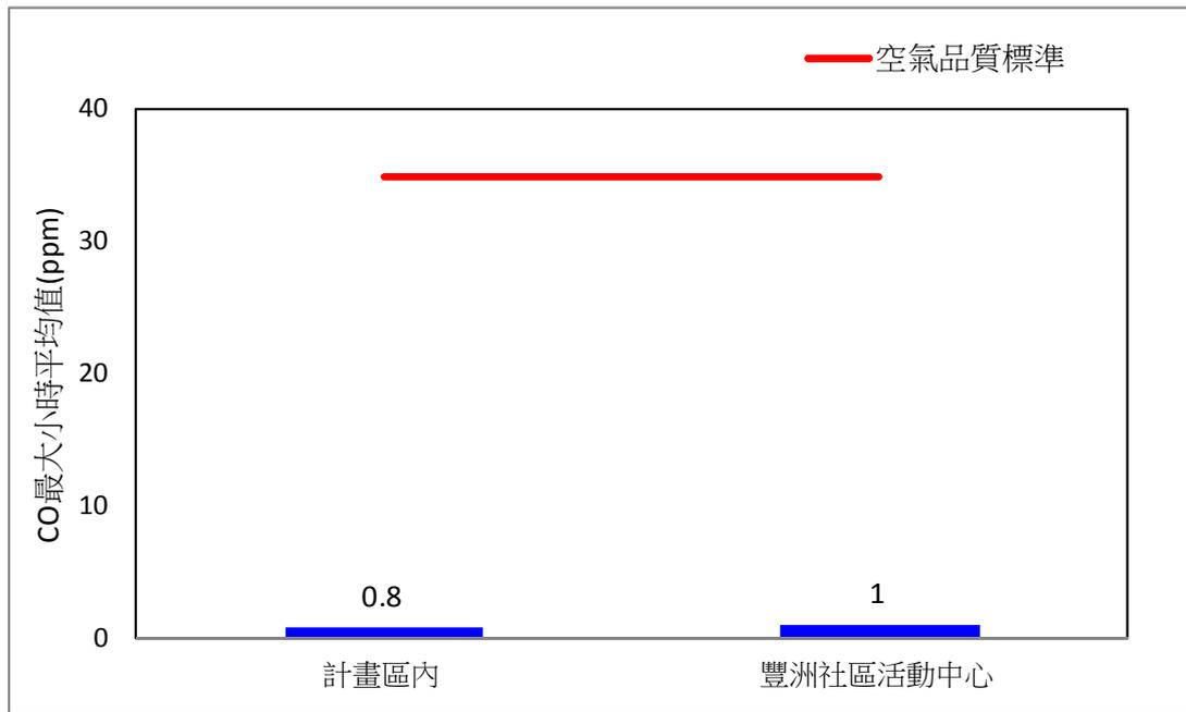
圖 2.3-5、108 年第一季空氣品質 CO 最大小時平均值監測比較圖
