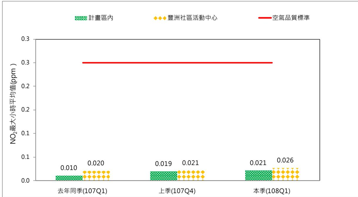
圖 3.1.1-39、本季、上季與去年同季施工暨營運期間空品 NO<sub>2</sub> 最大小時平均值監測成果
