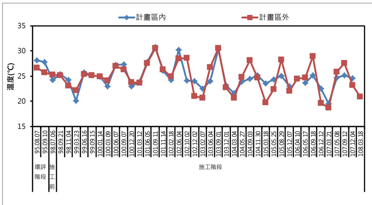
圖 3.1.1-27、歷次地下水質溫度監測結果
