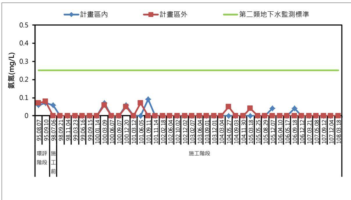
圖 3.1.1-31、歷次地下水質氨氮監測結果
