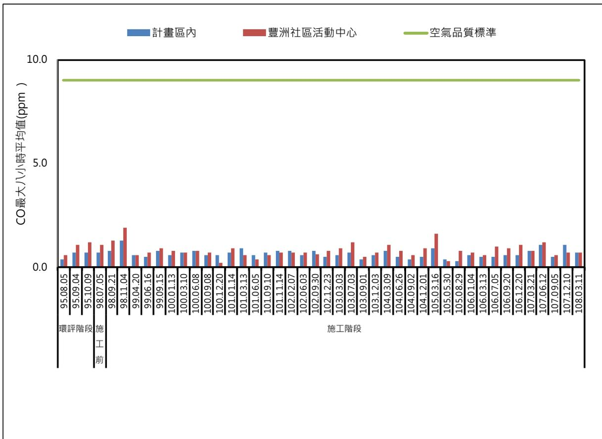
圖 3.1.1-51、歷次空氣品質 CO 最大八小時平均值監測結果
