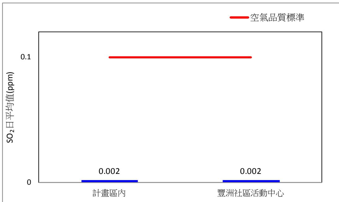
圖 2.3-4、108 年第一季空氣品質 SO<sub>2</sub> 日平均值監測比較圖
