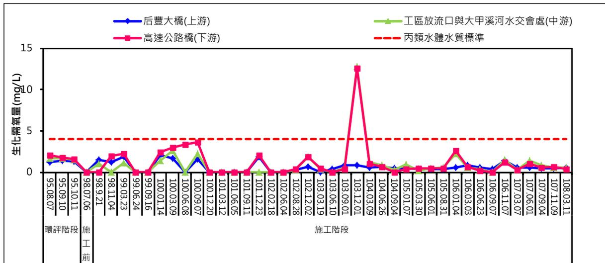
圖 3.1.1-14、歷次地面水質生化需氧量監測結果
