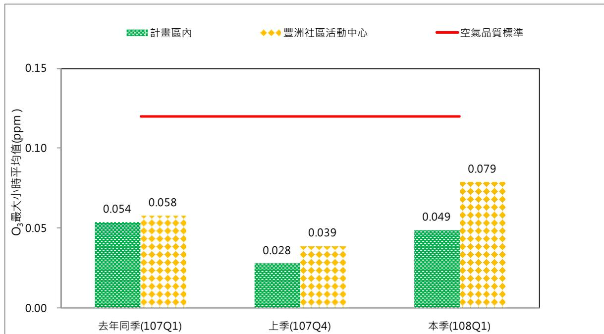
圖 3.1.1-40、本季、上季與去年同季施工暨營運期間空品 O<sub>3</sub> 最大小時平均值監測成果
