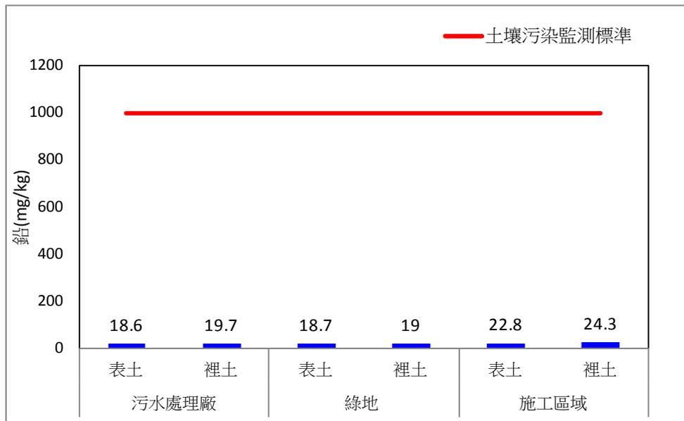
圖 2.4-1、108 年第一季土壤重金屬鉛監測比較圖
