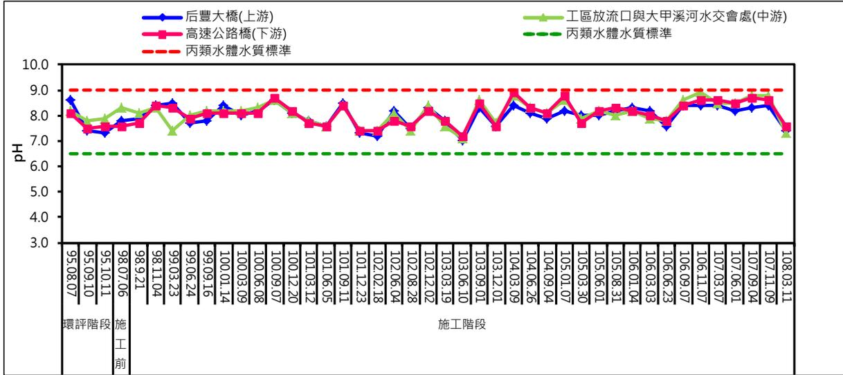
圖 3.1.1-12、歷次地面水質 pH 值監測結果
