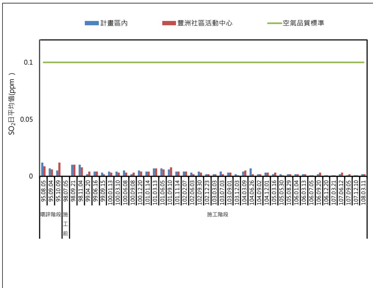
圖 3.1.1-47、歷次空氣品質 SO<sub>2</sub> 日平均值監測結果
