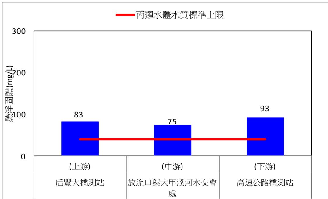
圖 2.1-3、108 年第一季地面水質懸浮固體監測比較圖
