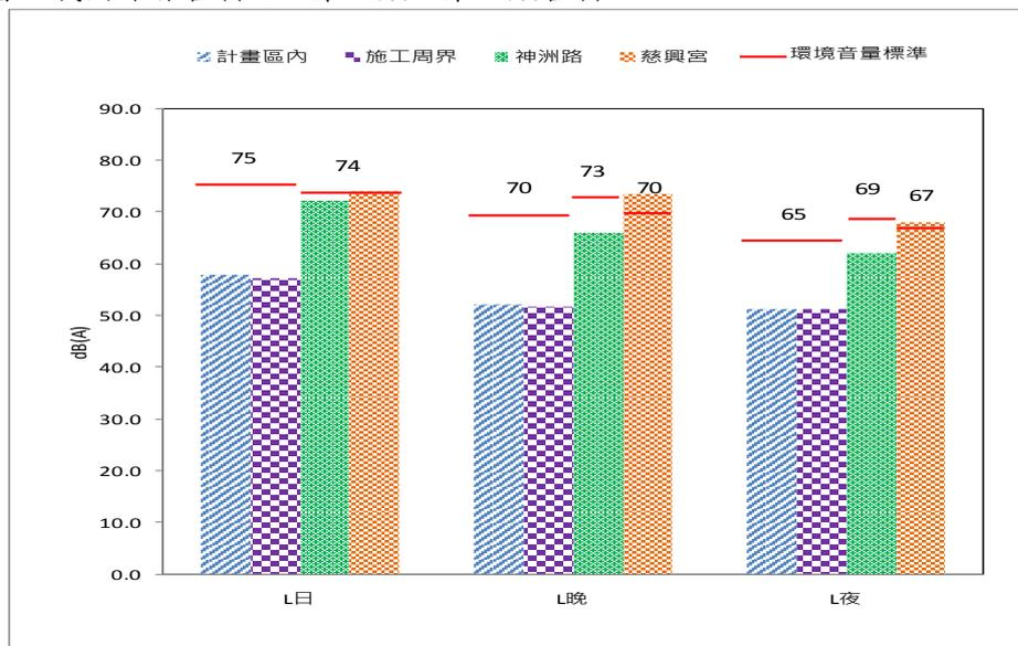
圖 2.5-1、108 年第一季各時段噪音監測值比較圖
