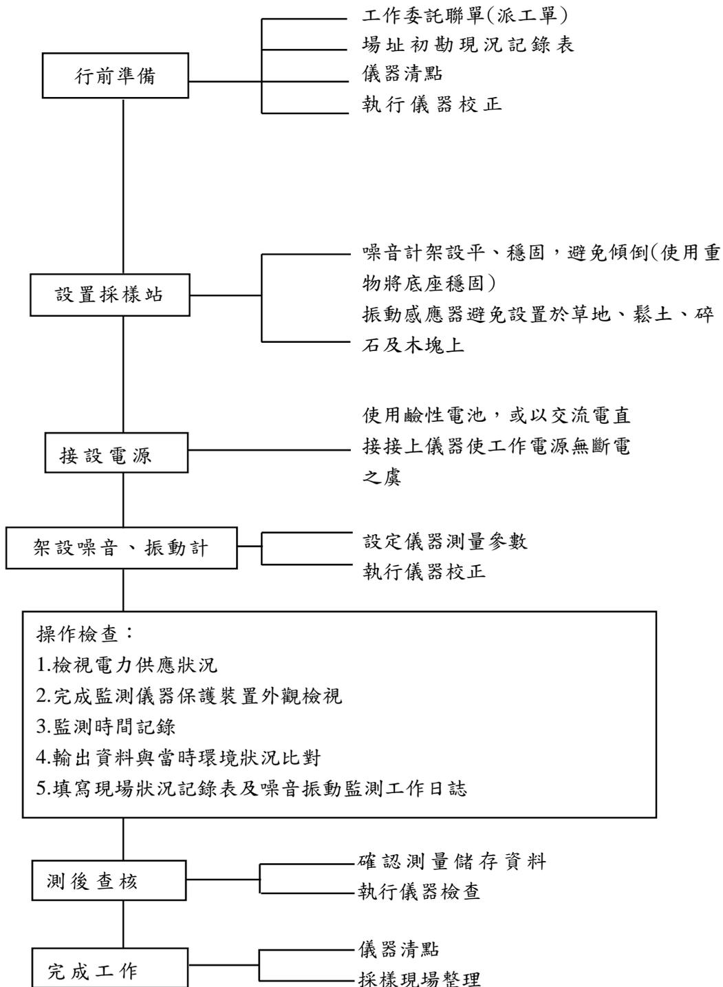
圖 1.5.1-4、噪音振動現場採樣流程
