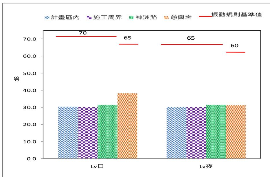
圖 2.5-2、108 年第一季各時段振動監測值比較圖
