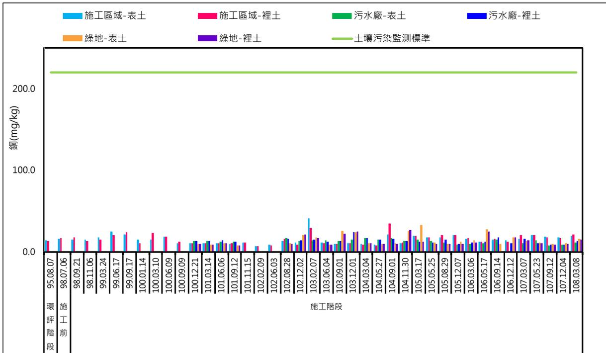
圖 3.1.1-61、歷次土壤重金屬銅監測結果
