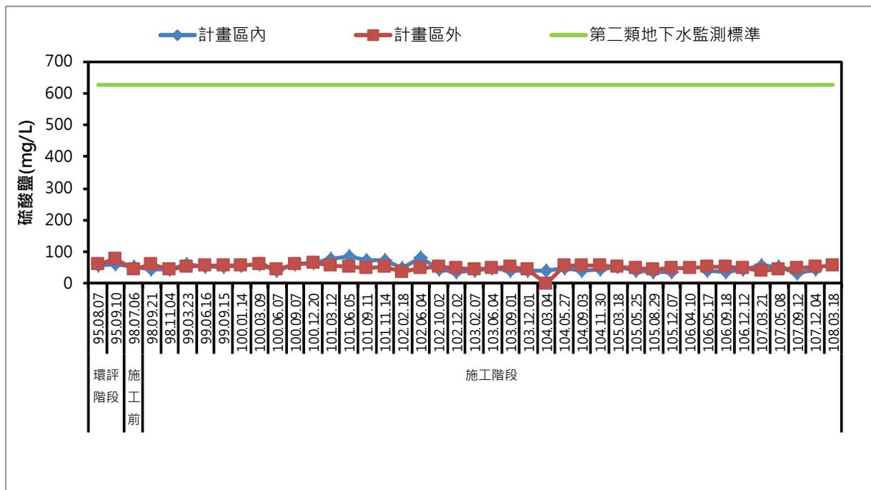
圖 3.1.1-29、歷次地下水質硫酸鹽監測結果
