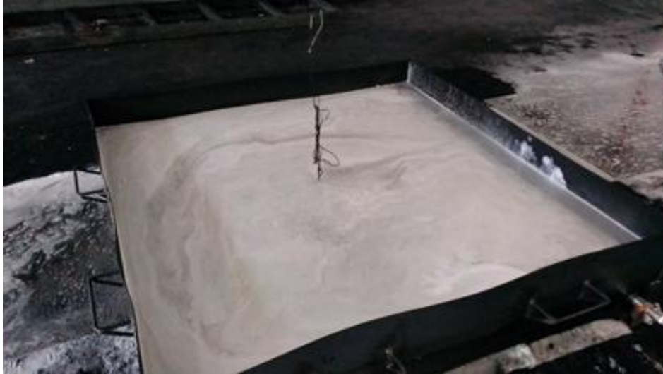
圖 5-12 泡沫滅火完成
