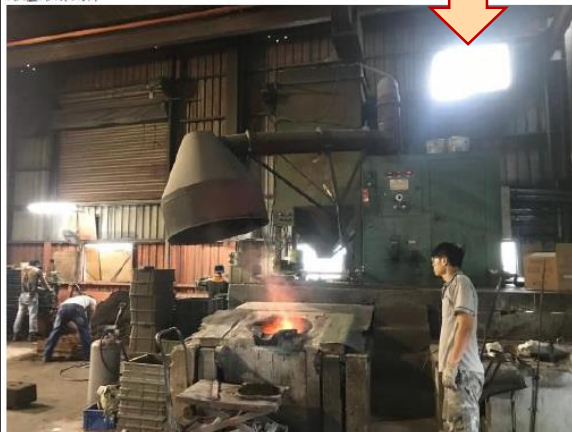
熔解後液體澆注至銅造模機
