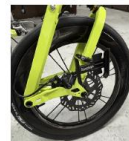
碳纖維陶瓷煞車碟盤安裝在實車上 圖2
